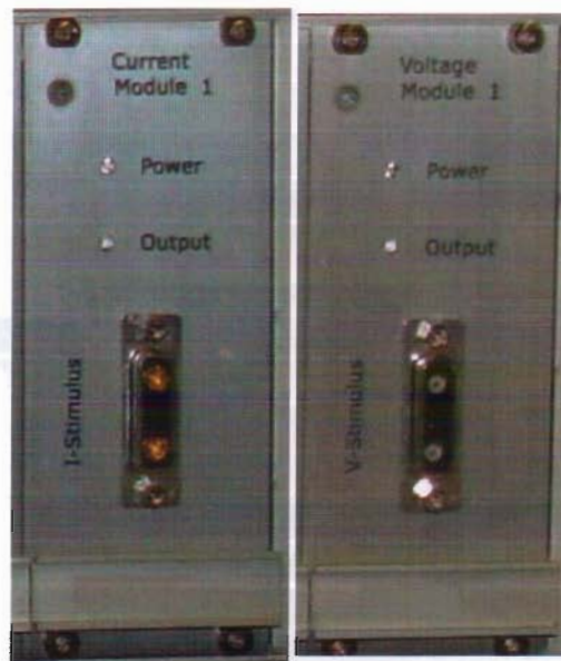
Figura 4: Moduli booster in corrente ed in tensione
